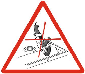
Le receveur ne doit subir aucune modification (sciage, meulage de renfort...)
