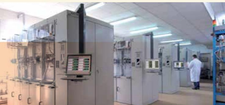
> Plate-forme d'endurance mécanique sur robinetterie sanitaire.
