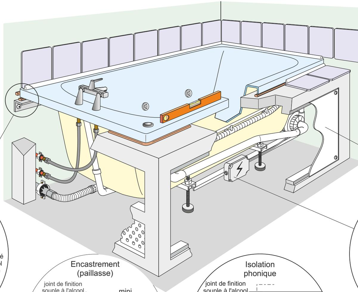
Utiliser les tabliers proposés par les constructeurs, ou bien réaliser une ou des trappes de visite adaptées à toute intervention et dépose.
