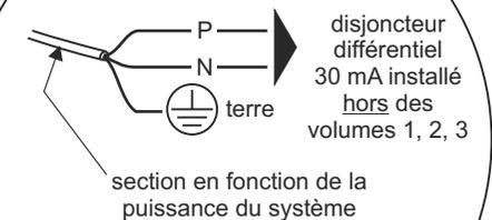
**L'installation électrique doit être réalisée par un électricien qualifié, conformément à la norme NF C 15.100, en respectant les liaisons équipotentielles**
